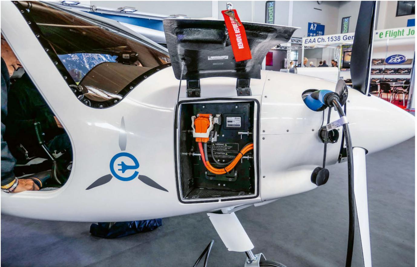
Der Aufbau des Alpha Electros. Gut sichtbar sind die orangefarbenen Starkstromkabel vom Motor zum Wechselrichter sowie die Ladebuchse auf der linken Seite.
