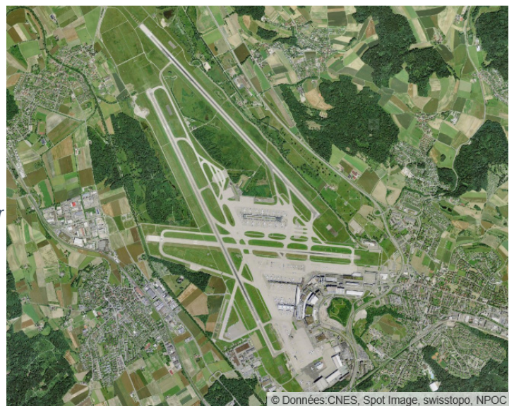
Bild 3: Eine vorübergehende oder dauerhafte Veränderung der vorherrschenden Windrichtung und -stärke kann auf Flughäfen mit sich kreuzenden Pisten eine Veränderung der Lärmbelastung bewirken. (Orthofoto: Flughafen Zürich. Quelle: map.geo.admin.ch)
