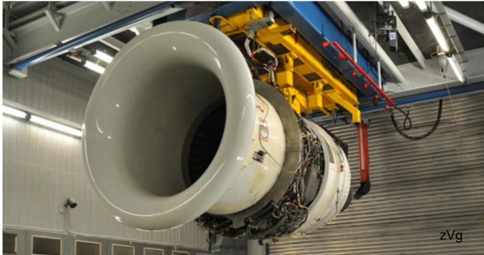
Bild: Testtriebwerk mit einziehbarer Abgassonde (hinten) für Feinstaubmessungen.
