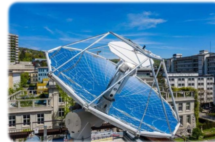
Solar-Mini-Raffinerie an der ETH Zürich
