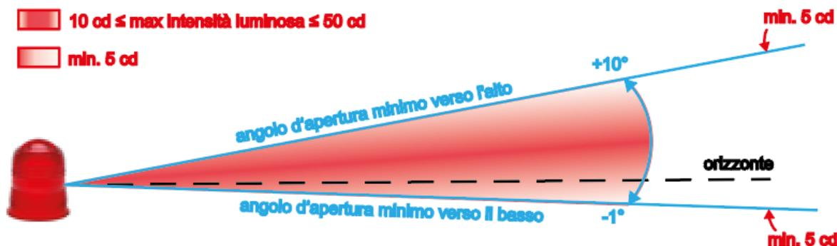
Illustrazione 108: rappresentazione schematica delle esigenze nel piano verticale per una luce d'ostacolo a bassa intensità (BI) nello spettro rosso.
