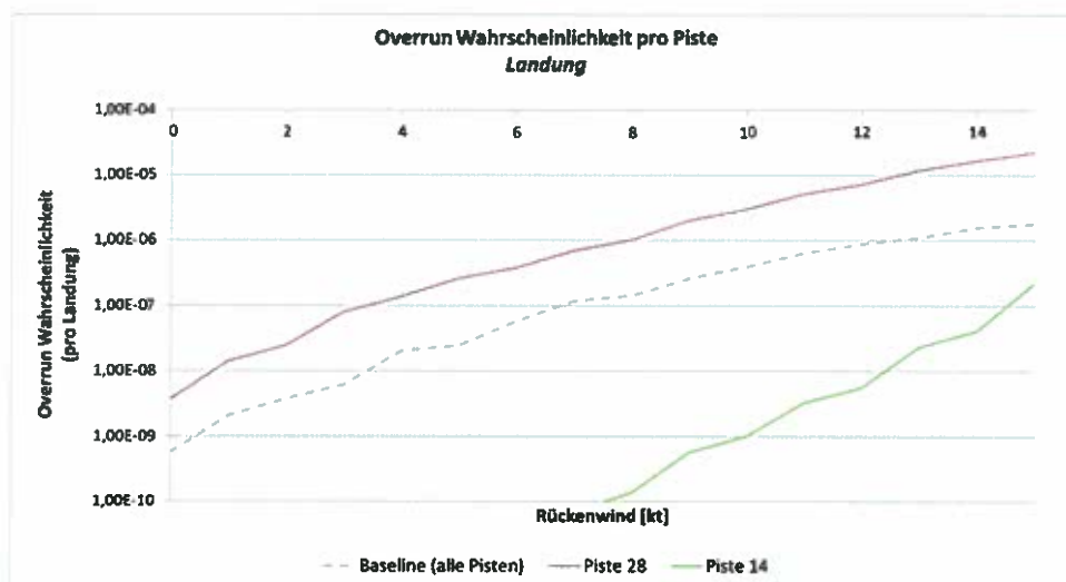
Abbildung 3: Overrun-Wahrscheinlichkeit bei Landung in Abhängigkeit der Rückenwindstärke (Quelle: Tailwind-Studie, GfL Dresden, 28.3.2014)
