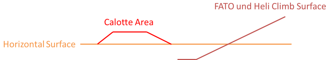
Abbildung 12: Schneidende und übereinander liegende OLS sind unabhängig und vollständig zu konstruieren (von der Seite betrachtet).
