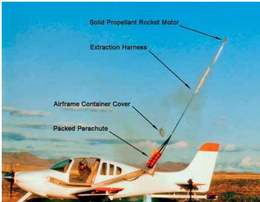
Der Öffnungsvorgang des ballistischen Fallschirms.
