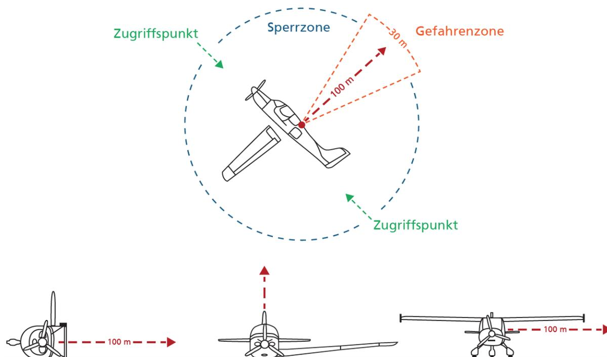
**Abbildung 10** Sicherheitszone, falls nicht ausgeschlossen werden kann, dass ein BPS eingebaut sein könnte [Quelle: Broschüre Ballistic Parachute Systems (BPS) bei Kleinflugzeugen (BAZL 13.10.2015)]
