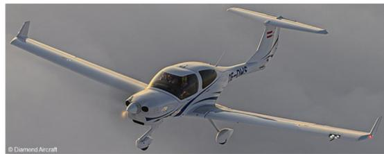
*Diamond DA40 NG, la version moteur à piston diesel (Jet A-1)*
