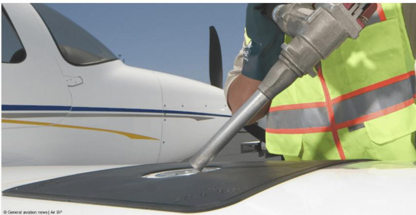
Avitaillement à l'aide d'une protection en silicone (tapis)
