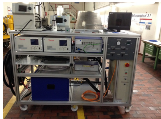
Foto 2: Il sistema svizzero di misurazione delle polveri fini prodotte dai motori degli aerei
