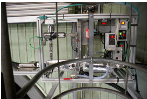
Foto 2: Il sistema svizzero di misurazione delle polveri fini prodotte dai motori degli aerei
