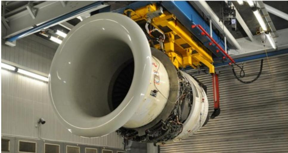
Foto 1: Motore per test con sonda retrattile (posteriore) per la misurazione delle polveri fini contenute nei gas di scarico
