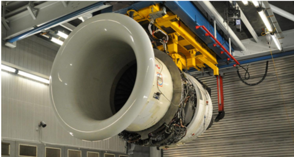
Foto 1: Motore per test con sonda retrattile (posteriore) per la misurazione delle polveri fini contenute nei gas di scarico
