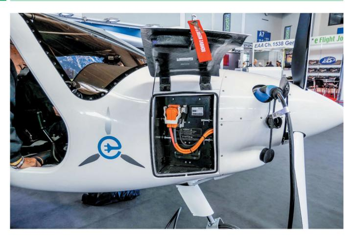
Costruzione dell'Alpha Electros. Si vedono bene i cavi arancione a corrente forte che collegano il motore all'ondulatore così come la presa di carica sul lato sinistro.
