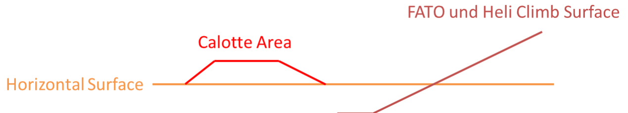
Abbildung 10: Schneidende und übereinander liegende OLS sind unabhängig und vollständig zu konstruieren (von der Seite betrachtet).
