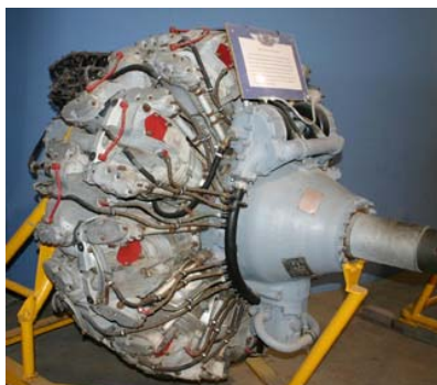
Bild 3: Tausende Stunden im Magerbetrieb: Der Wright R-3350 Motor (DC7 etc.) wurde im Reiseflug mager betrieben. Die bessere Gemischkontrolle wurde z.B. erreicht durch symmetrischen Motoraufbau (gleichmässige Gemischzufuhr und Kühlung), Gemischeinstellung auf der Grundlage von Treibstoffverbrauch und Leistung, sowie einem Flugingenieur, welcher die Bedienung und kontinuierliche Überwachung des Motors übernahm.
