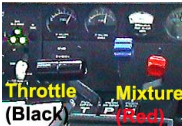
Bild 2: Gashebel (schwarz), Propellerverstellung (Blau) und Gemischhebel (Rot).
