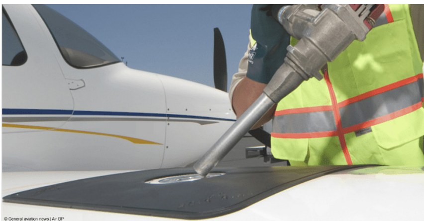
Silikonmatte zum Schutz der Tragfläche beim Betanken
