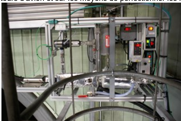
Illustration : le système suisse de mesure des particules fines émises par les réacteurs d'avion.
