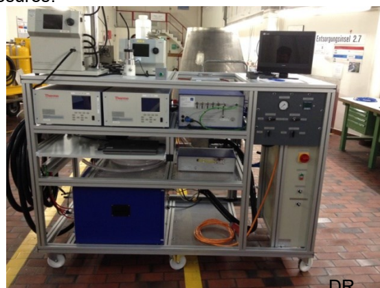
Illustration : le système suisse de mesure des particules fines émises par les réacteurs d'avion.
