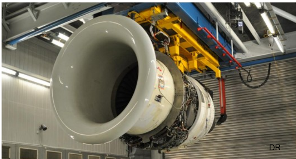
Illustration : le réacteur test et sa sonde de gaz d'échappement rétractable (à l'arrière) utilisée pour mesurer les particules fines.
