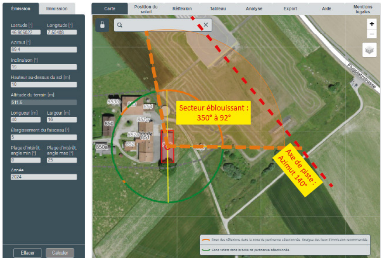
Figure 1 : Exemple à l'aide de Blendtool : L'axe de piste pertinent a un angle d'azimut de 140°. L'angle minimal entre le rayon éblouissant et l'axe de la piste est donc de 140^\circ - 92^\circ = 48^\circ et n'est donc pas critique (résultat > 25^\circ ).
