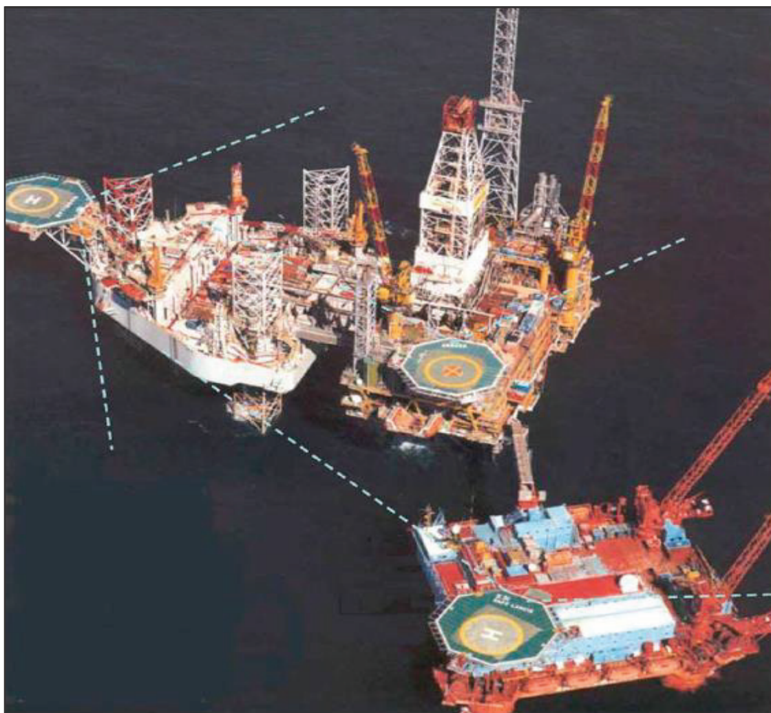
Figure I-4-3. Opération combinée temporaire montrant la position relative de chaque secteur de 210° de l'héliplate-forme
