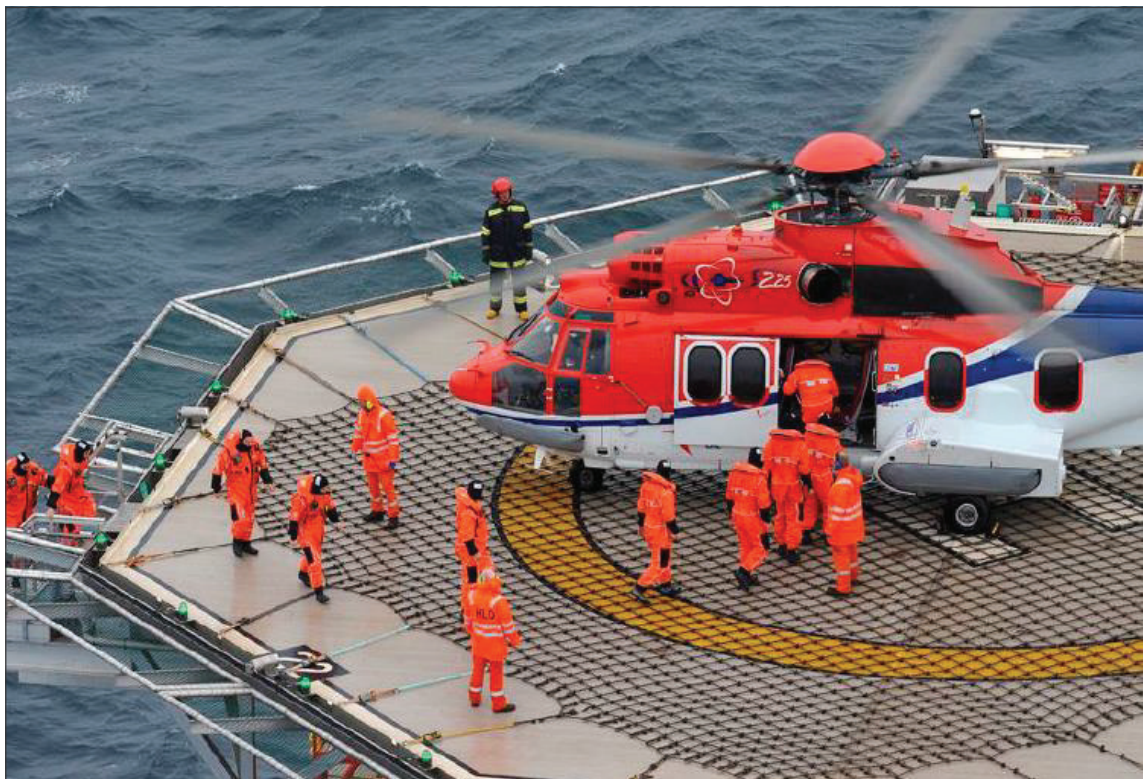
Figure I-5-6. Positionnement précis d'un hélicoptère grâce à l'utilisation correcte du cercle de la marque de prise de contact/positionnement (TD/PM)
