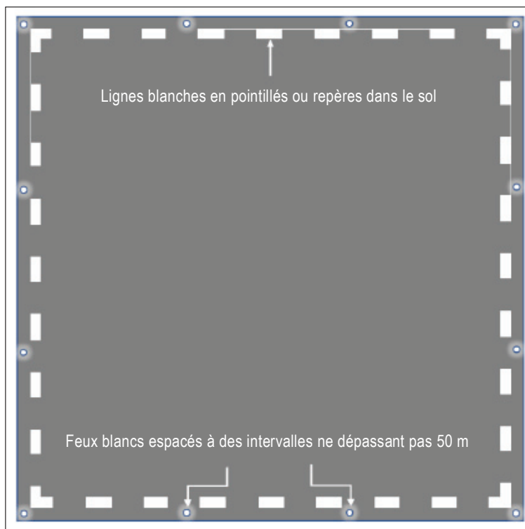
Figure II-5-10. Marque de périmètre pour un niveau de surface autre que celui d'une FATO de type piste
