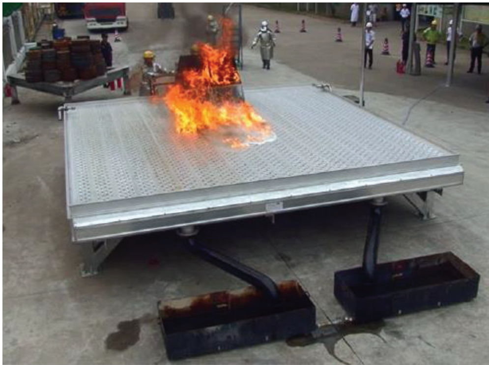
Figure II-6-6. Essai d'incendie sur une surface anti-feu passive (200 litres de combustible en feu)
