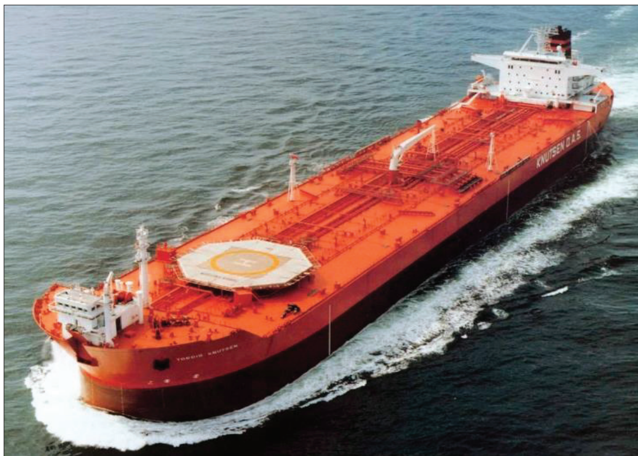
Figure I-1-5. Navire-citerne avec hélistation construite spécialement sur l'axe longitudinal du navire
