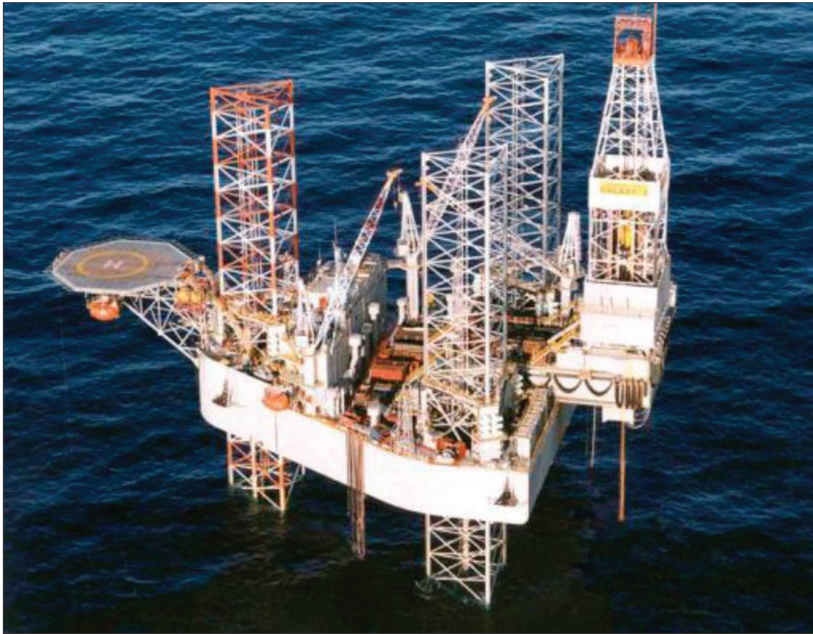
Figure I-1-3. Unité mobile de forage en mer auto-élevatrice à trois piles relevées
