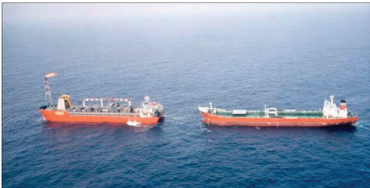
Figure I-1-4. Le pétrolier (à droite) se raccorde à une FPSO (à gauche)
