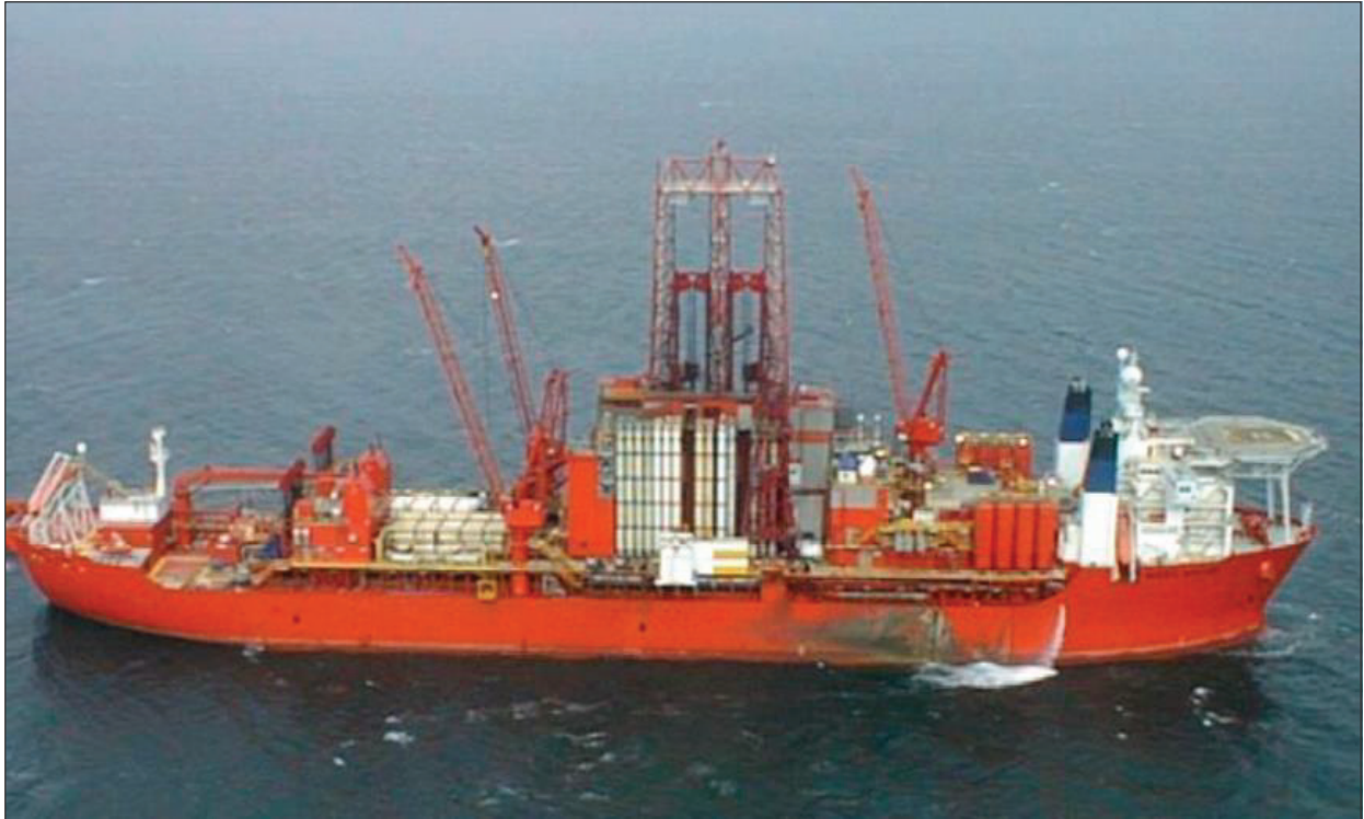
Figure I-1-6. Héliplate-forme de proue montée en hauteur sur un navire de forage
