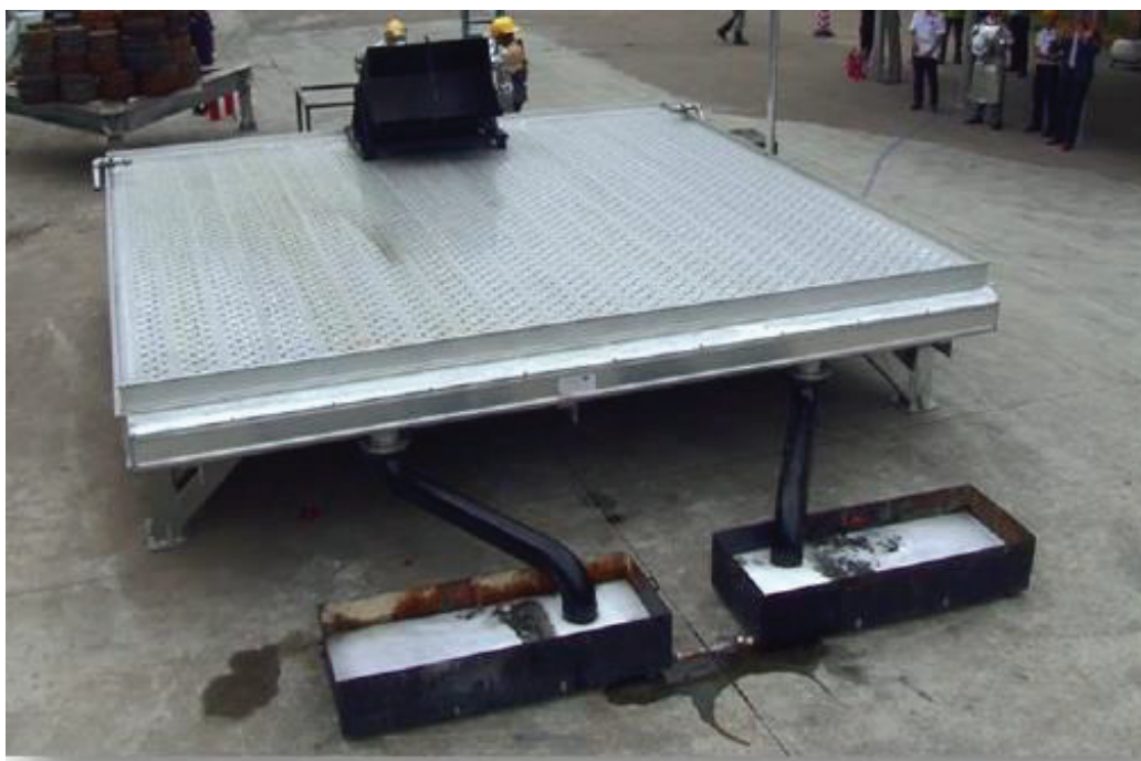
Figure II-6-7. Essai d'incendie sur une surface anti-feu passive (180 litres de combustible sont recueillis)
