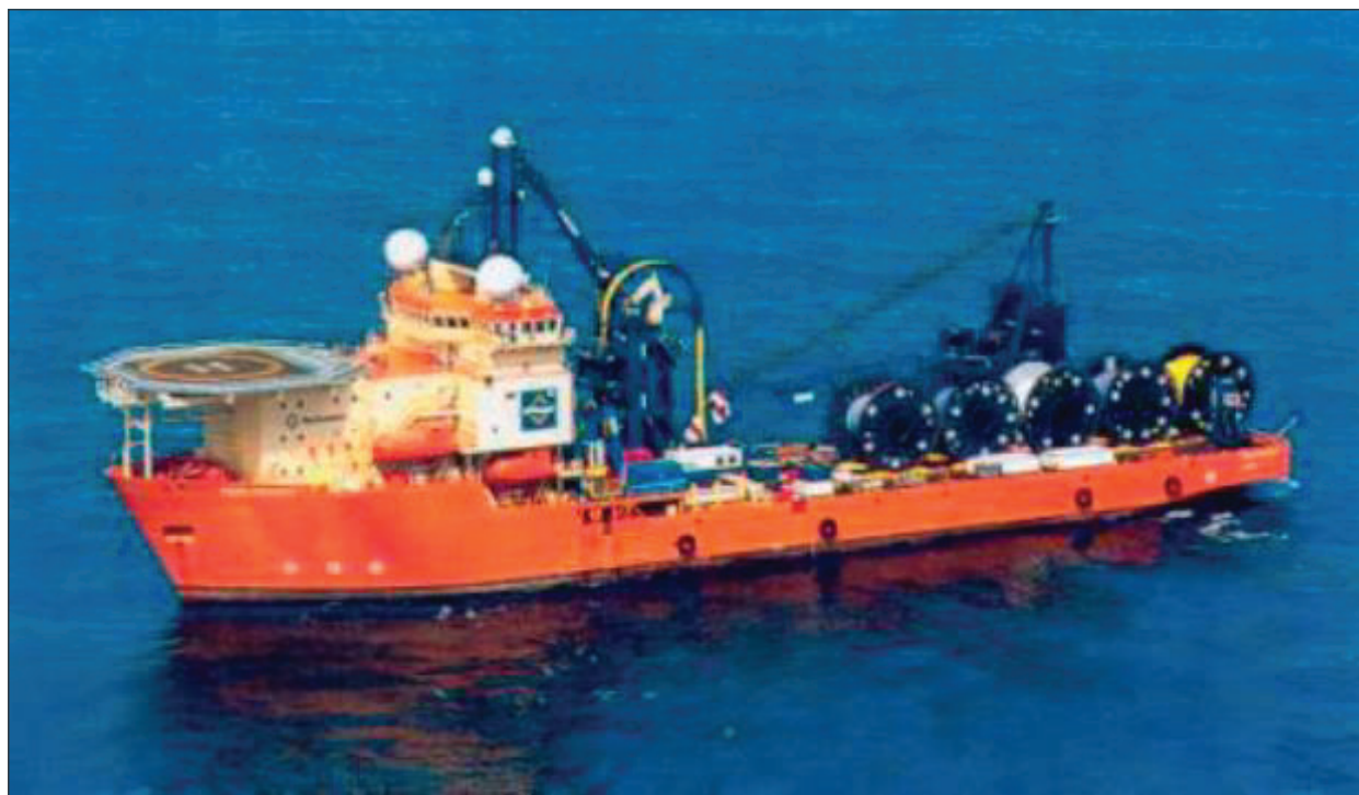
Figure I-1-7. Héliplate-forme en terrasse montée à la proue d'un navire de pose de tuyaux
